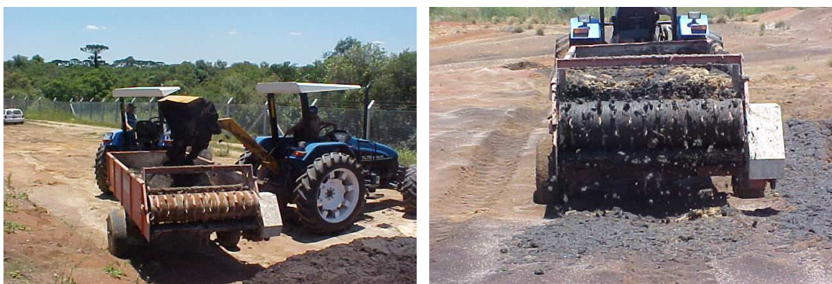
FIGURA 05: CARREGAMENTO DO BIOSSÓLIDO NO EQUIPAMENTO DE DISTRIBUIÇÃO E APLICAÇÃO NA PARCELA EXPERIMENTAL. AEROPORTO INTERNACIONAL DE CURTIBA.
