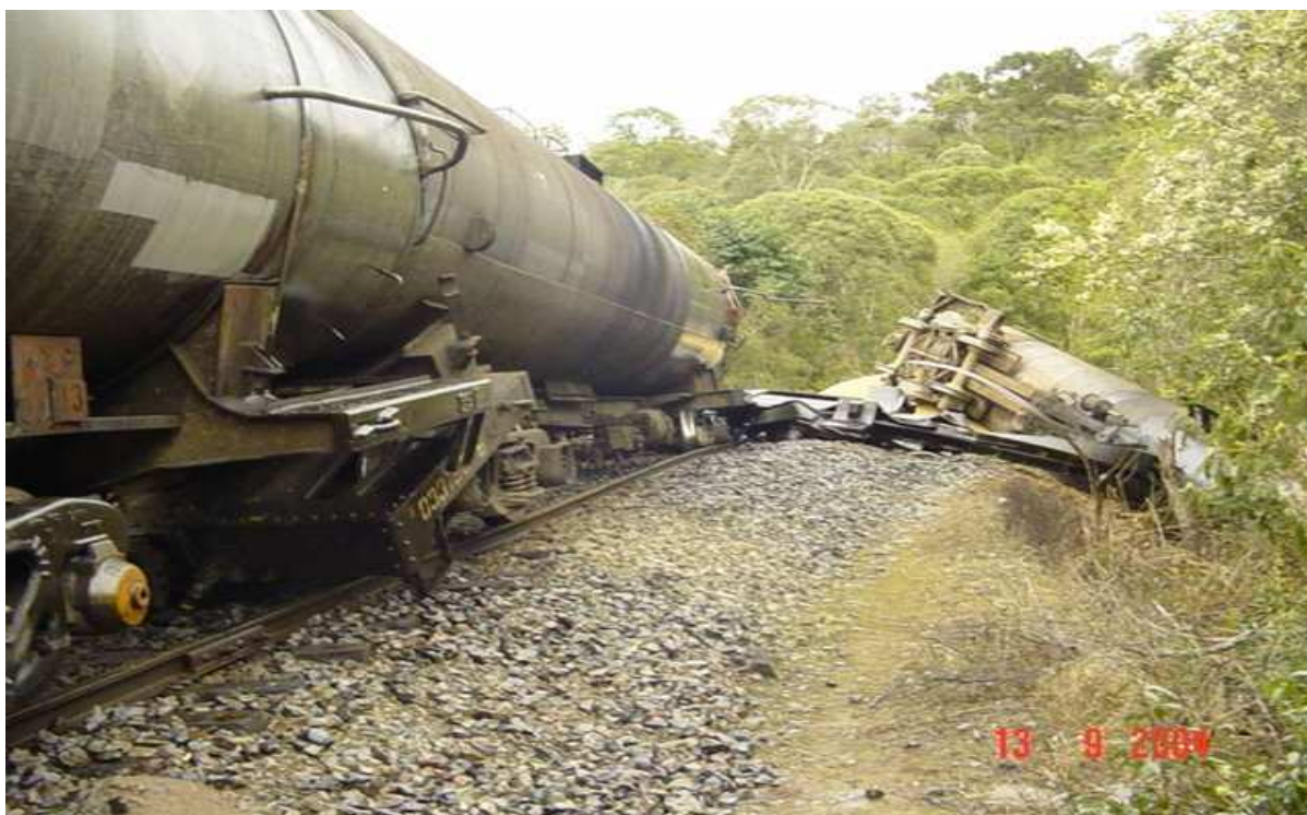
Figura 03: "Vagões Tanque Descarrilhados"
