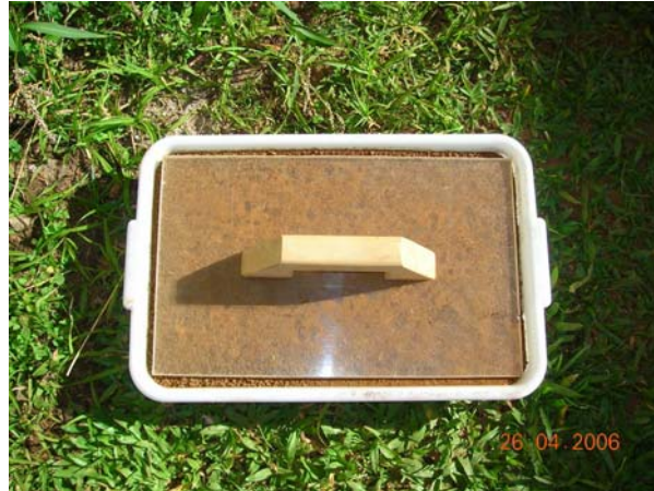
FOTO 3 – ADENSAMENTO DO SOLO SOBRE A CAMADA DE AREIA.
