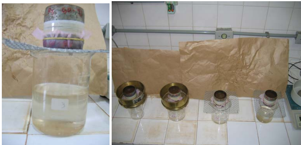
FOTO 2 - METODOLOGIA ADAPTADA DO PERMEÂMETRO DE CARGA CONSTANTE
