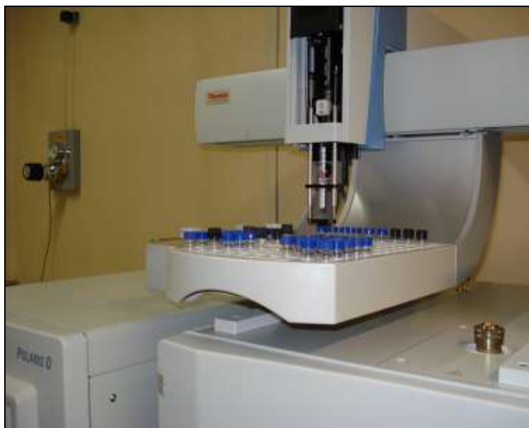
FIGURA 3 - INJEÇÃO DAS AMOSTRAS NO CROMATÓGRAFO GASOSO
