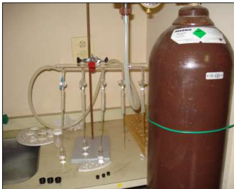
FIGURA 2 - SECAGEM COM FLUXO DE NITROGÊNIO
