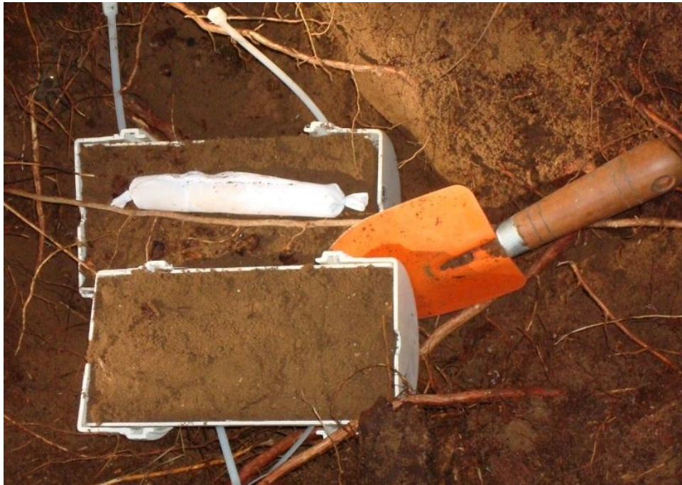
Figura 2.2. Tubo rizosférico contendo cilindro de nylon com mineral particulado.
