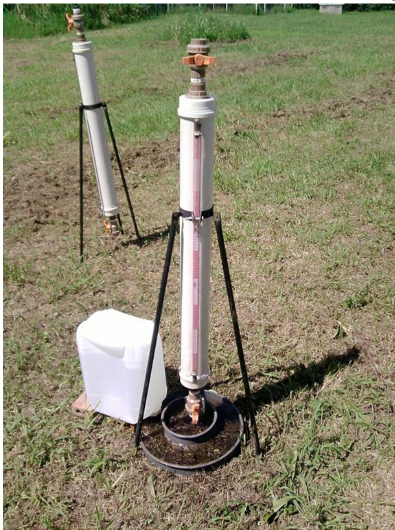
Apêndice 3. Detalhe dos infiltrômetros de anéis concêntricos instalados à campo.
